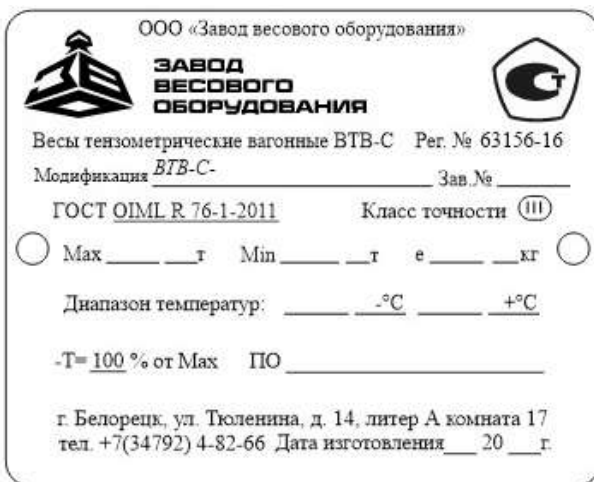
Рис.1 – Общий вид маркировочной таблички однодиапазонных (слева) и многодиапазонных (справа) весов
